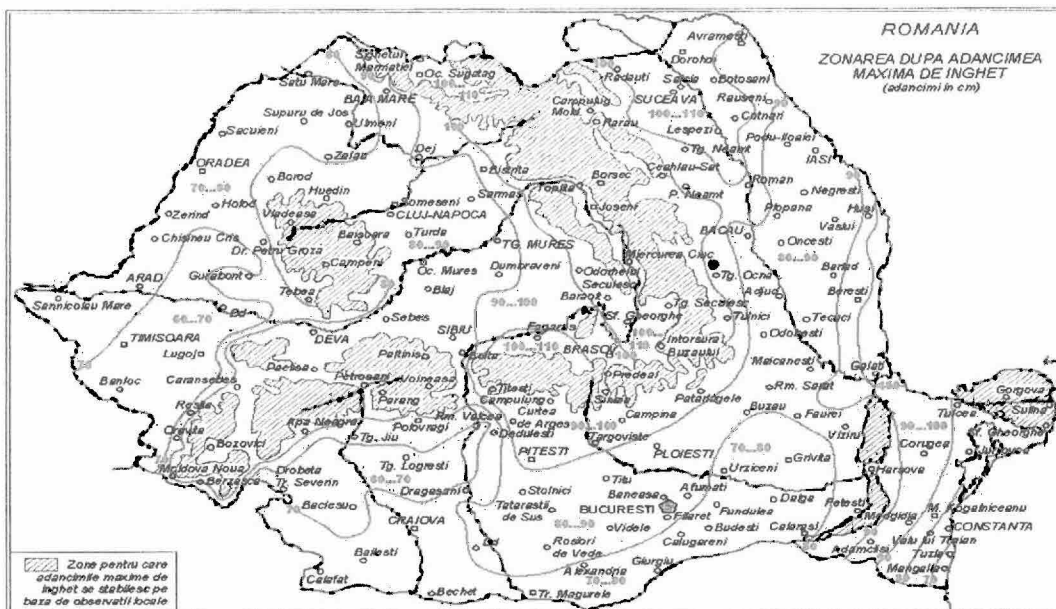
Zonarea teritoriului Romaniei după adâncimea de îngheț, conform STAS 6054/77 „Adâncimi maxime de îngheț”
